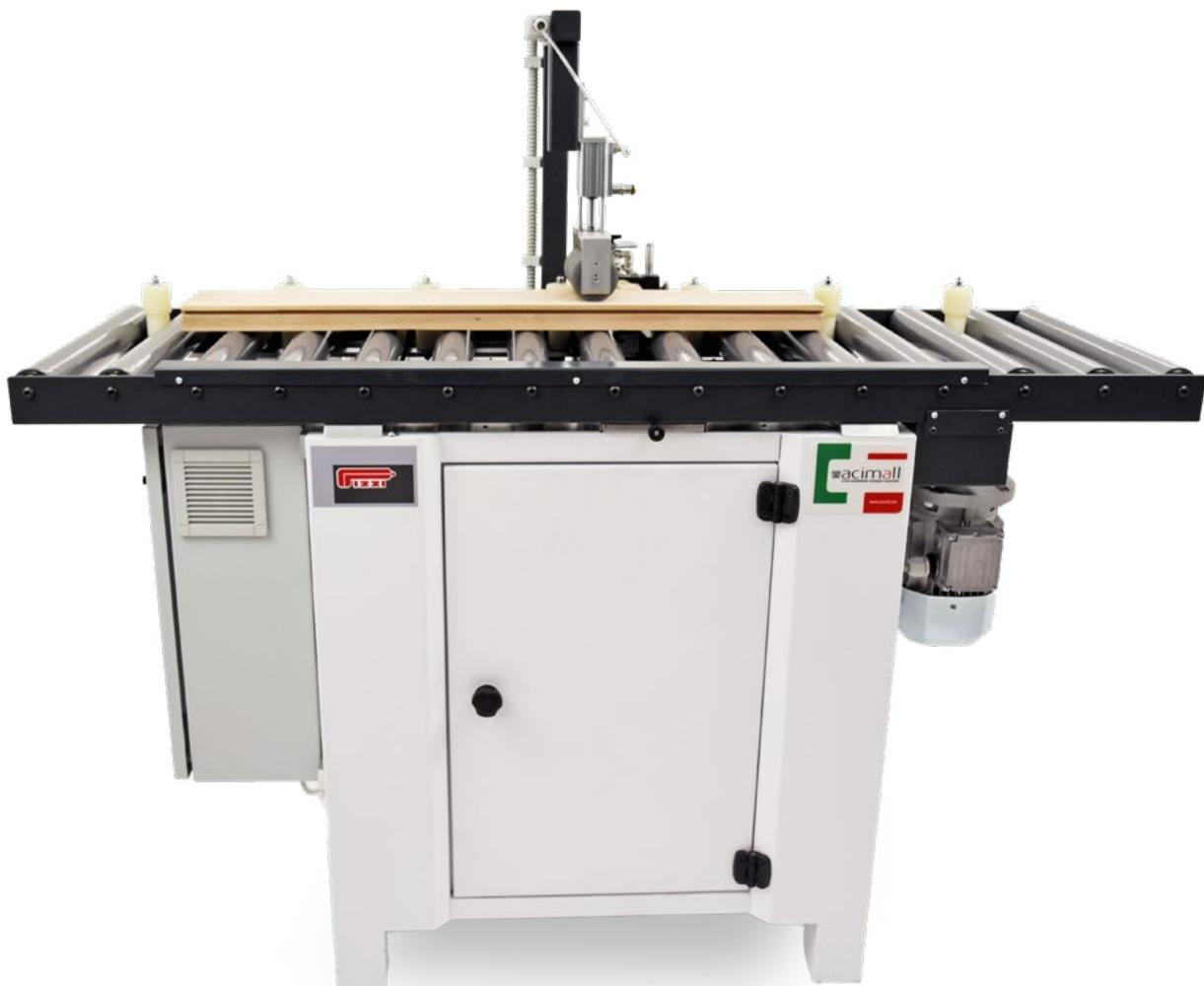
Modello con avanzamento regolabile tramite rulli motorizzati e inverter.
