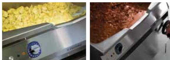
Ranhura de despejo facilita as operações. Basculamento manual com controlo preciso.
