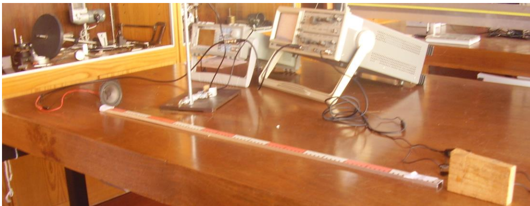
Fig.1 Montagem para medição da velocidade do som
