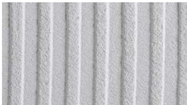
AUS Modellierputz (superfície modifica com espátula dentada)
