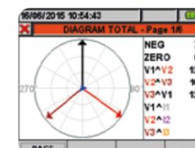
Diagramma vettoriale di tensioni e correnti
