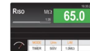
Misura di resistenza di isolamento.
