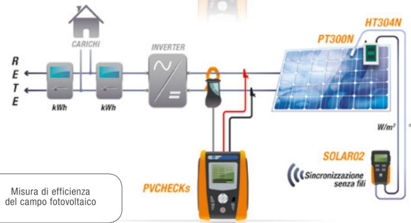
Misura di efficienza del campo fotovoltaico
