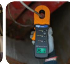
Misura resistenza di terra con pinza T2100.
