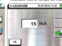
Misura della corrente di dispersione con pinza opzionale HT96U.
