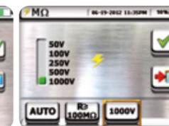
Selezione tensione di prova e valore limite minimo su misura MC.
