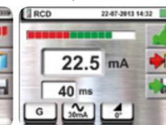
Risultato test a rampa su RCD.
