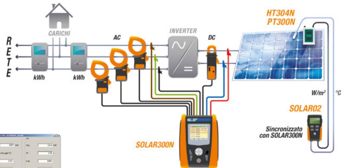
Schema di connessione (Sistema trifase)
