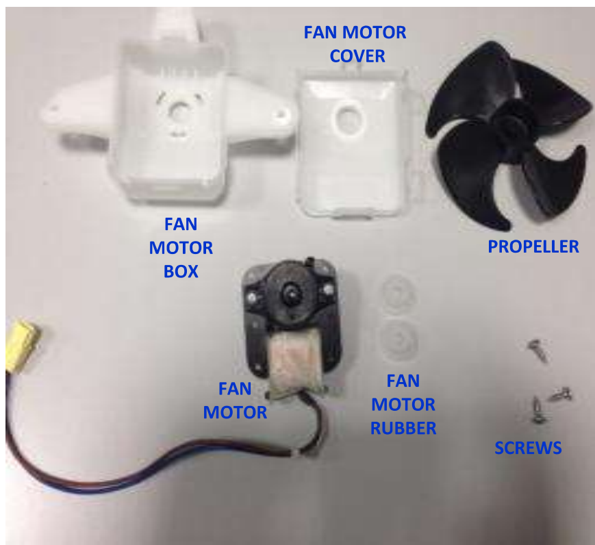
Fan Motor Components
