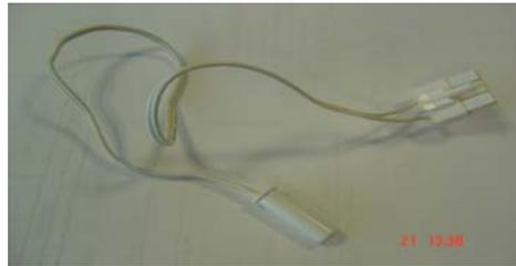
**RT ERROR:** RT-sensor (sensor temperatura ambiente en placa) desconectado / en corto.
