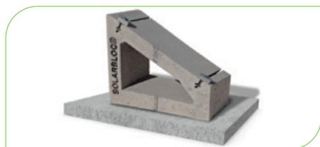
Por sua vez, as estruturas SOLARBLOC H-S/18 são um formato de grande formato destinado à construção de parques solares em terrenos problemáticos por falta de resistência ou tensão, onde não podem ser realizadas fundações ou cravações. Possuem um centro de gravidade baixo para dar estabilidade ao conjunto e são fabricados em 4 ângulos diferentes - 15°, 20°, 25°, 30°.
