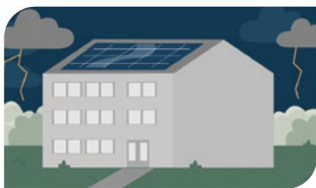
2. Os edifícios com proteção externa contra raios com uma distância de segurança de  $s \geq 0,7 \text{ m}^{***}$  requerem um DPS CC Tipo II (de acordo com a EN\* 61643-31) com cabos de ligação à terra de 6 mm<sup>2</sup>.
