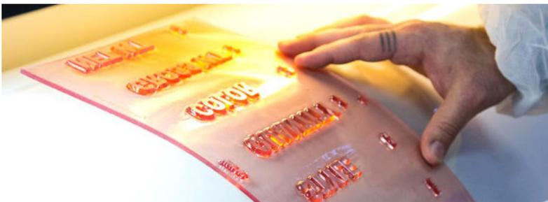
**FLEXOGRAFIA** - Processo de impressão saco-a-saco, permite a impressão de gráficos simples e texto em duas faces (frente e verso) do saco de asa retorcida.
