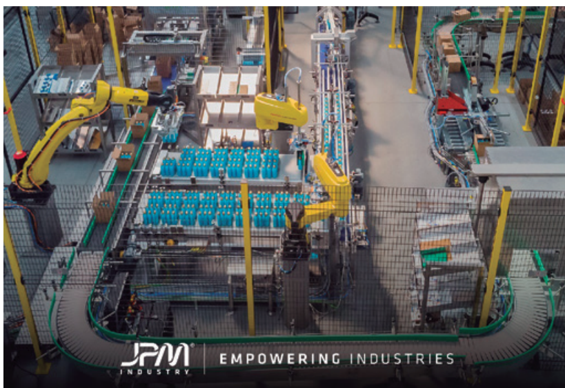
Figura 1. Célula robótica com manipuladores industriais, com as barreiras de proteção visíveis no primeiro plano (fotografia gentilmente cedida pelo Eng. Guilherme Cardoso (JPM Industry)).
