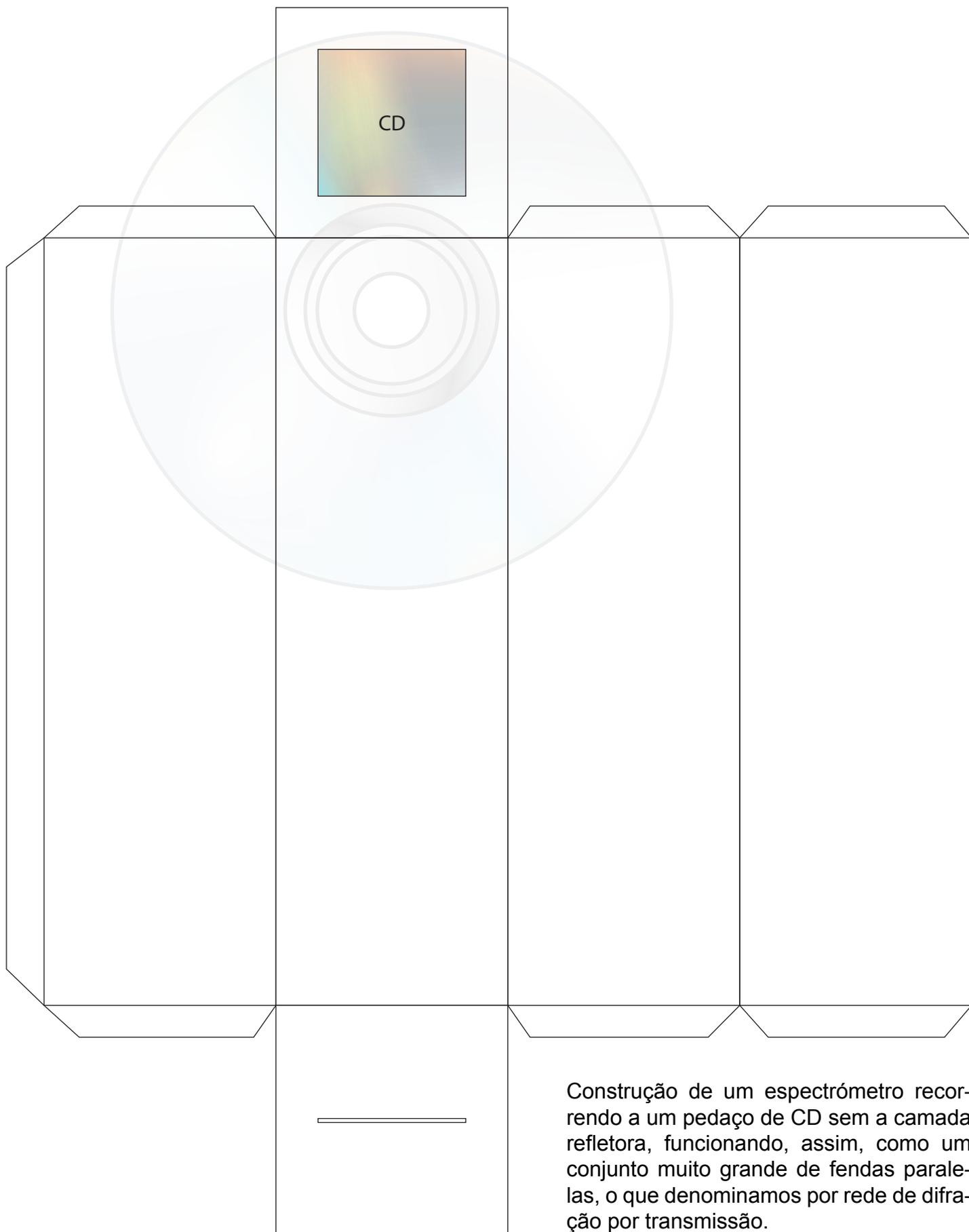
Construção de um espectrómetro recorrendo a um pedaço de CD sem a camada refletora, funcionando, assim, como um conjunto muito grande de fendas paralelas, o que denominamos por rede de difração por transmissão.
