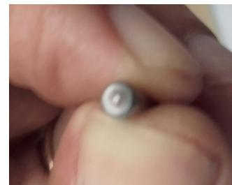
Figura 4 – Verificação final da correção do empeno – anel centrado no topo do veio.
