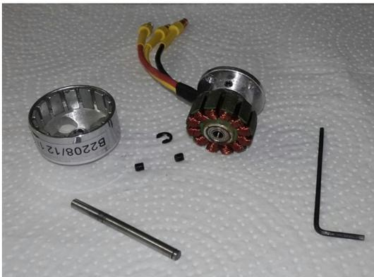
Figura 1 – Motor desmontado
