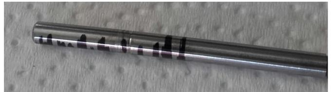
Figura 2 – Marcas indicando a parte saliente do empeno
