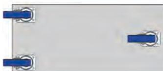
Três rodízios giratórios com mesma altura de montagem
