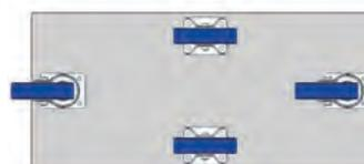
Dois rodízios giratórios e dois rodízios fixos, tendo os rodízios fixos uma altura de montagem ligeiramente superior
