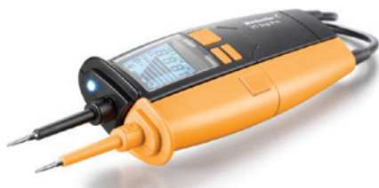
Figura 2. Novo método de medição RMS TRMS - graças à TRMS, a VT Digi Pro não é apenas adequada para medir tensões senoidais na faixa CA. Agora também podem ser testadas e medidas, por exemplo, tensões que são "perturbadas" por harmónicos.
