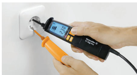
Figura 2. Novo método de medição RMS TRMS - graças à TRMS, a VT Digi Pro não é apenas adequada para medir tensões senoidais na faixa CA. Agora também podem ser testadas e medidas, por exemplo, tensões que são "perturbadas" por harmónicos.
