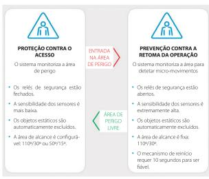
O sistema alterna automaticamente entre 2 estados: a proteção contra o acesso e a prevenção contra a retoma da operação. Caso se detete a entrada de um operador numa área de perigo, o sistema condiciona o equipamento para que este se posicione de forma segura. Por outro lado, ainda que se acione o equipamento para retomar a operação enquanto o operador se encontra na área perigosa, o sistema LBK bloqueia o robot, prevenindo assim a retoma acidental da operação.
