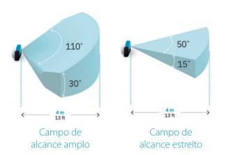
ampla, obtem-se um ângulo de abertura horizontal de 110º e vertical de 30°. Na configuração de uma área de alcance mais estreita, o ângulo de abertura horizontal é de 50° e o vertical é de 15°.
