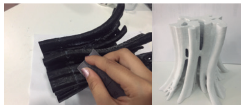
Figura 13. Lixagem e aplicação de primário nos protótipos.
