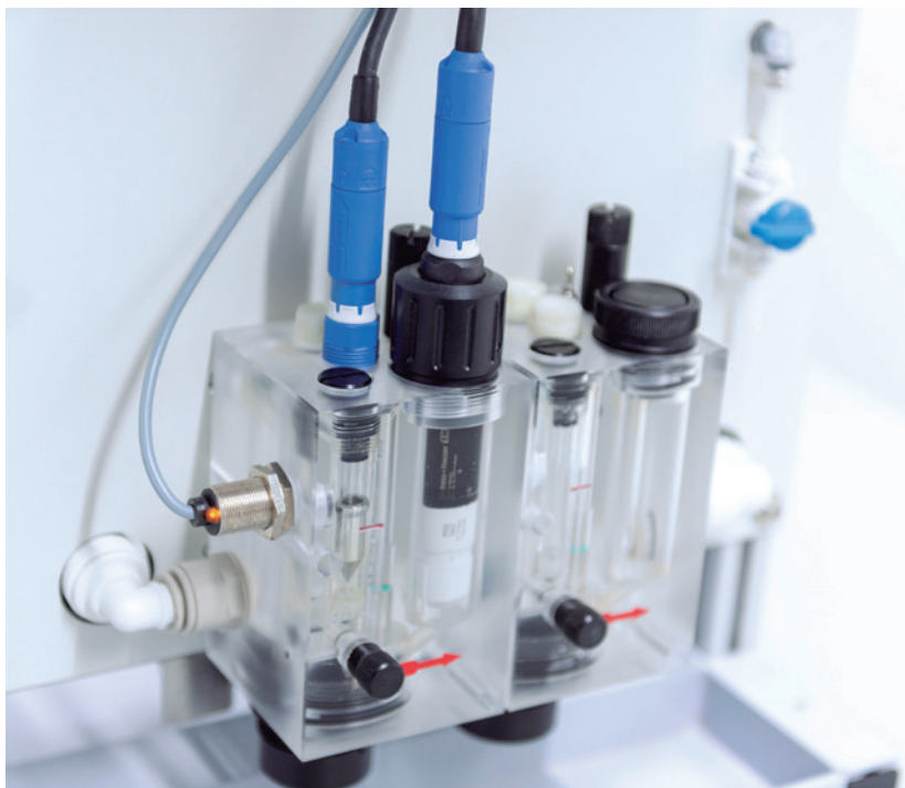
Figura 1. O sensor de cloro livre Memosens CCS51D instalado no Flowfit CCA250 juntamente com o sensor Memosens CPS31D pH para compensação de pH.
