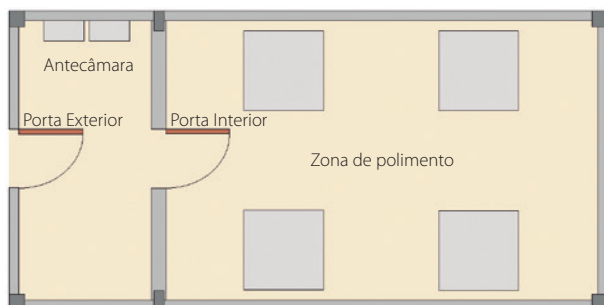
Figura 1. Planta da cabine de polimento.
