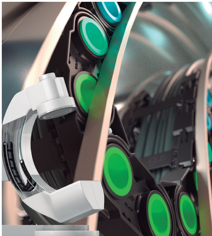
Figura 1. O princípio da lokchain: pernos automaticamente extensíveis (a azul) fixam a lokchain na guia. Quando o elo roda na curva, o pino retrai automaticamente (a verde) e solta a calha. Graças à sua flexibilidade, a calha articulada pode ser utilizada, por exemplo, em aparelhos de radiologia. (Fonte: igus GmbH)
