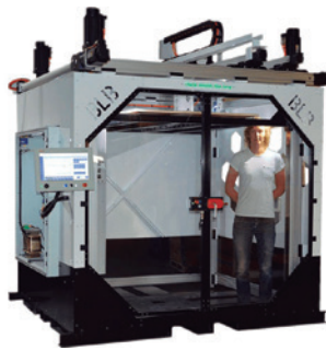
Figura 17. THE BOX, impressora com tecnologia de extrusão FGF com volume de construção 1500 x 1100 x 1500 mm [7].
