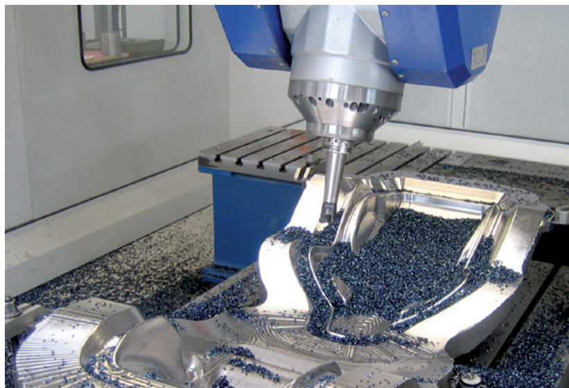
Figura 1. Peça complexa de um molde durante a fresagem.
