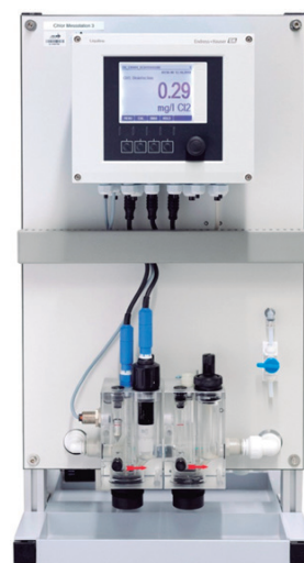
Figura 3. Composto por um transmissor multiparámetros Liquiline e um sensor de cloro livre Memosens CCS51D, o sensor de pH Memosens CPS31D pH e o conjunto de fluxo Flowfit CCA250.
