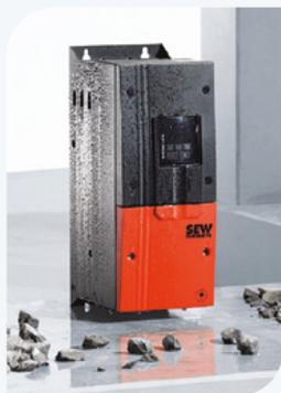
Os conversores de frequência da série MOVITRAC® LTP-B foram desenhados para satisfazer os requisitos das aplicações que exigem instalação fora do quadro elétrico, oferecendo um índice de proteção *standard* IP55. Foram desenvolvidos para controlar a velocidade dos motores assíncronos ou síncronos sem *encoder* e são especialmente económicos em aplicações de transporte, sistemas de elevação, ventiladores e bombas. Recentemente a SEW-EURODRIVE expandiu a série dos MOVITRAC® LTP-B com a
