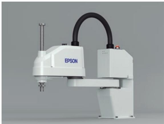
da do *robot* T3. O T6 pode ser equipado com manipuladores terminais pesados, como manipuladores terminais duplos para agarrar dois objetos em simultâneo, para ajudar os fabricantes a aumentarem a produtividade das fábricas.
