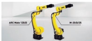
A FANUC aumentou a sua extensa gama de modelos com 2 novos robots: o robot de processamento industrial M-20iD/25 e a versão de soldadura ARC Mate 120iD. Ambos são caracterizados por uma maior velocidade de eixos e por uma maior área de trabalho em comparação com os seus antecessores. Estes dois novos robots são controlados pelo controlador R-30iB Plus.
