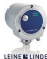
Na série de *encoders* FSI 900 da Leine Linde existem variantes de *encoders* com sinais de saída incremental. O FSI 900 é um sistema de segurança integrado num *encoder* com uma leitura indutiva absoluta. O sistema de segurança pode monitorizar fins de curso, aceleração,
