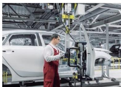
O sistema da Festo deteta o peso da carga e ajusta automaticamente a força de compensação, mesmo quando as massas são adicionadas ou removidas em suspensão em processos de produção que são especialmente flexíveis e com uma grande quantidade de variantes. A operação é muito simples com um siste-
