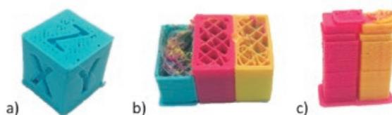
Figura 7. Algumas peças realizadas com a apresentação de erros de a) mau acabamento superficial, b) escorregamento do sistema de extrusão, c) desalinhamento na construção de peças.
