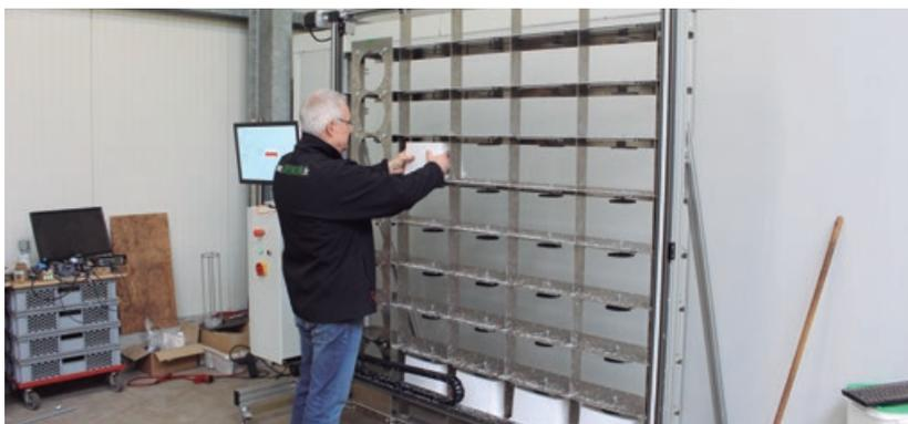
**Figura 6.** Um robot linear tridimensional drylin da igus ajuda na furação automática de orifícios de ventilação em baldes para a criação de minhocas. A perfuradora de baldes assume uma tarefa não apreciada pela família Langhoff e poupa custos. (Fonte: igus GmbH)
