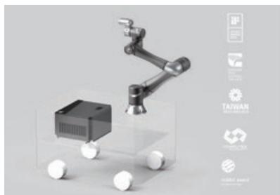
A série móvel TM-M da Techman Robot, composta pelas versões TM5M-700, TM5M-900, TM12M-1300 e TM14M-1100, são alimentados a 20-60 V DC, tornando-os compatíveis com a maioria das marcas de AGVs e outros veículos móveis. Através da utilização dos TM – Landmark, os robots móveis podem orientar-se num espaço 3D, como uma sequência de dados automática, para servir várias máquinas. Isto permite que os TM-M possam operar entre duas ou mais posições sem problemas.
