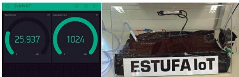
Figura 3. Estufa automatizada IoT.
