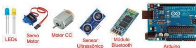
Figura 2. Alguns componentes eletroeletrónicos da RP.
