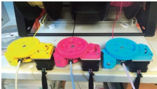
Figura 9. Sistema de extrusão com a introdução de um mecanismo de redução de transmissão.
