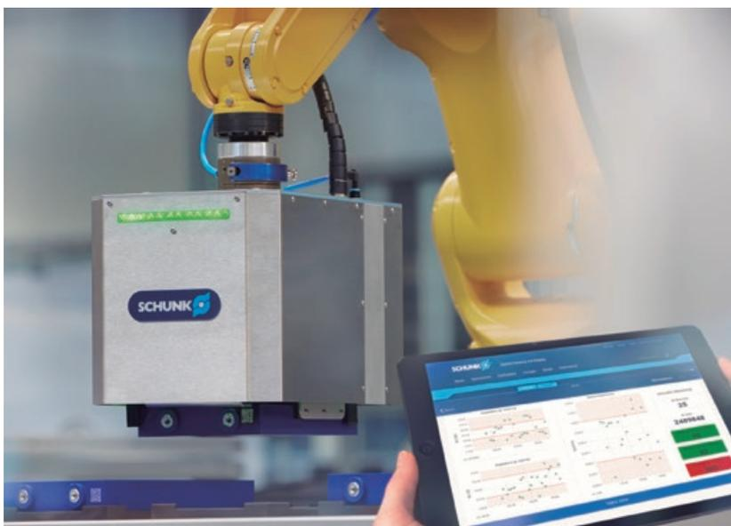
**Figura 1.** A pinça inteligente da SCHUNK para as células de bateria determina todos os parâmetros geométricos e elétricos das células de íões de lítio para o controlo de qualidade durante a manipulação. Deste modo realiza-se uma importante contribuição para a produção inteligente de baterias.
