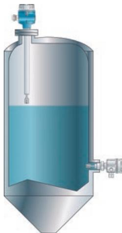
Figura 1. O princípio de medição Vibronics.
