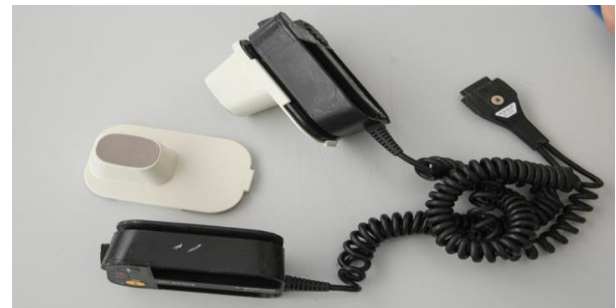
Figura 75 – Pás manuais com atenuadores de energia
