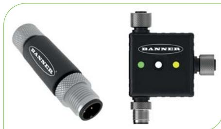
Os conversores S15C recebem vários tipos de sinais (discretos, analógicos e RTD) transformando-os comunicáveis em protocolos industriais inteligentes como IO-Link ou convencionais como o Modbus. Ferramentas como conetores M12 *standard*, caixa IP67 compacta, configuração simplificada e acessórios de montagem opcionais simplificam a integração desses produtos nas infraestruturas de controlo.
