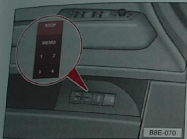
Com os botões da memória na porta do condutor podem ser memorizadas e chamadas quatro posições diferentes e regulações dos espelhos exteriores\*. O sistema também funciona com a ignição desligada.
