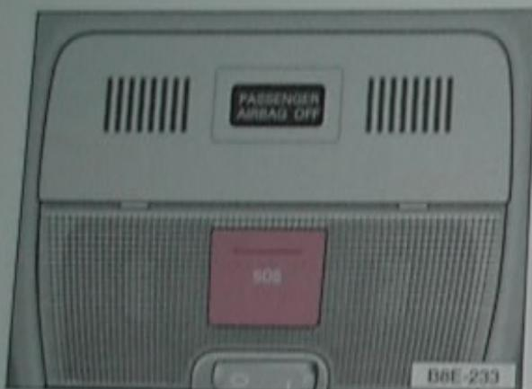
Nos veículos com sistema telemático existe por baixo de uma tampa (ver figura) uma unidade de chamada de emergência de SOS e assistência. A tampa abre-se, exercendo sobre ela uma ligeira pressão.
