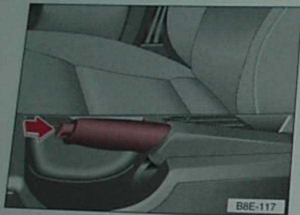
Para accionar o travão de mão, puxe a alavanca firmemente. Numa descida, engate adicionalmente a 1ª velocidade e, no caso da caixa automática, o bloqueio de estacionamento. Também por isso o travão de mão deve ser puxado firmemente para evitar que o carro circule, por inadvertência, com o travão accionado.
