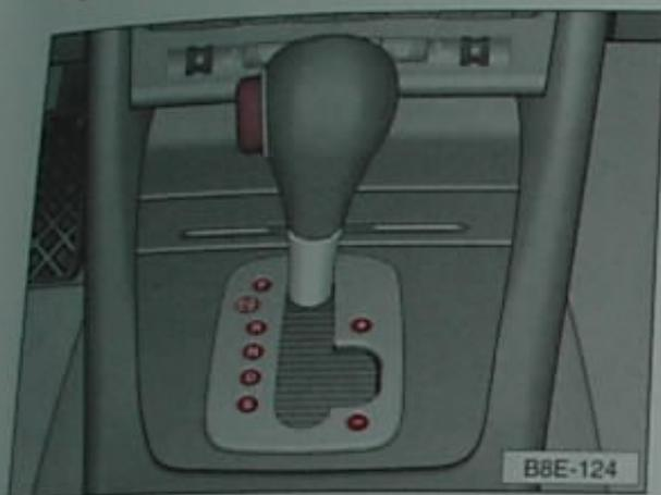
A figura mostra uma caixa de 5 velocidades automática de comando electrónico.
