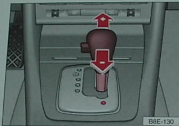
Deslocando a alavanca selectora para a frente (+) é seleccionada uma marcha superior, deslocando-a para trás (-) é seleccionada uma marcha inferior.
