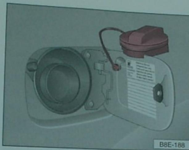
O tampão desenroscado pode ser pendurado na tampa do depósito. O tipo de combustível a utilizar está indicado no autocolante afixado no interior da tampa – ver figura da direita.
