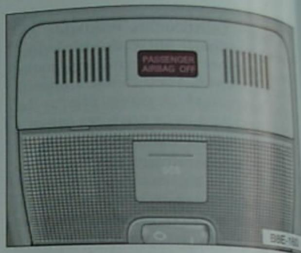
Se o airbag do passageiro tiver sido desligado, a luz avisadora do airbag do passageiro, reproduzida na figura de cima, acender-se-á em permanência.
