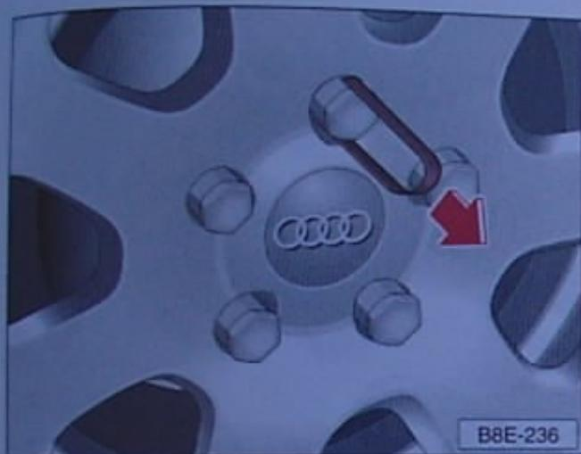
Para se ter acesso aos parafusos em certas jantes de liga leve, é preciso remover as tampas de resguardo por cima dos parafusos com a ajuda do gancho de plástico que faz parte das ferramentas de bordo (ver figura).
