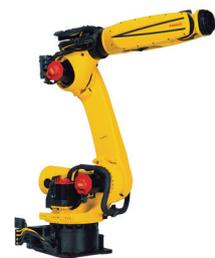
O R-2000iD, novo modelo da série R-2000 é a principal novidade na integração de cabos J1-J6 no braço e no punho do *robot* o que reduz a tensão, evitando interferências. Juntamente com os cabos de longa duração recentemente otimizados para o R-2000iD, verifica-se uma redução do tempo e dos custos de manutenção. Apesar dos cabos estarem totalmente integrados no braço e no punho do *robot* existem várias aberturas que garantem um acesso fácil.
