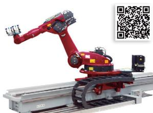
A célula robotizada de quinagem ESI proporciona uma maior precisão nas operações, o que leva a um aumento da qualidade do produto final. Consegue-se incrementar a velocidade de trabalho, o que resulta num aumento da cadência produtiva. Através de um sistema constituído por Máquina quinadora + Robot + Gripper + Eixo de movimento linear; é possível realizar automaticamente operações de quinagem de chapa, sem recurso a um operador.
