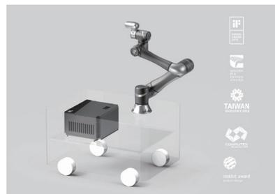
A série móvel TM-M da Techman Robot, composta pelas versões TM5M-700, TM5M-900, TM12M-1300 e TM14M-1100, são alimentados a 20-60 VDC, tornando-os compatíveis com a maioria das marcas de AGVs e outros veículos móveis. Através do uso dos TM – Landmark, os robots mó-
