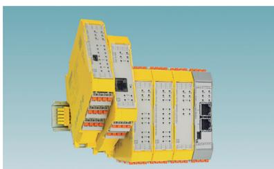
O novo sistema de segurança modular da Phoenix Contact destina-se a aplicações de segurança funcional até "PL e" e "SIL 3". O portefólio é composto por vários módulos de segurança, cada um com uma largura de 22,5 mm, equipados com ligação a parafuso ou *Push-in*. Através de uma base TBUS para calha DIN, os módulos de segurança podem ser dispostos um ao lado do outro sem configuração.
