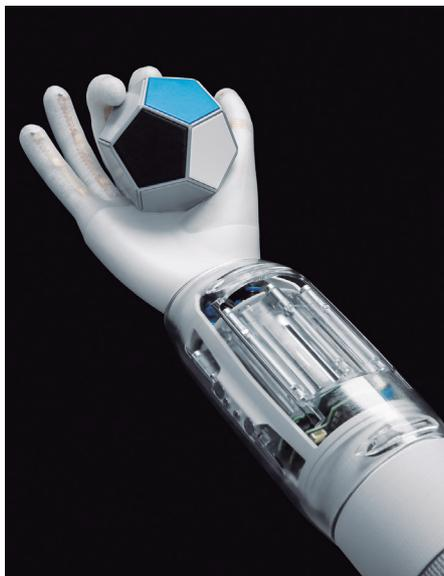
Combinando a robótica com Inteligência Artificial é possível criar movimentos biônicos no braço e na mão robótica. A BionicSoftHand é composta por câmaras de ar cobertas por um material têxtil flexível que possibilitam imitar o movimento de uma mão humana. O ar é bombeado para dentro e para fora das câmaras através de tubos de borracha, o que possibilita que esta se dobre numa determinada direção,
