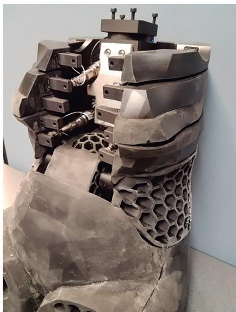
**Figura 5.** Tronco de ATD com componentes obtidos por Impressão 3D.
