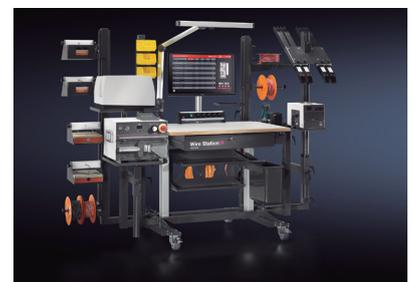
A cablagem de componentes na construção e fabrico de painéis é a etapa em que ainda é necessário trabalho manual. Mesmo que o processamento do fio seja automatizado, por exemplo, com o Rittal Wire Terminal, os fios ainda são instalados no armário ou na placa de montagem manualmente. Além disso, os cabos com secções transversais maiores também necessitam de ser instalados manualmente
