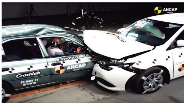
**Figura 3.** Teste de colisão entre os modelos Toyota Corolla: à esquerda com a versão de 1998 e à direita com a versão de 2015. As lesões para o condutor são mais graves no veículo mais antigo. Fonte da Imagem: [www.roadandtrack.com/car-culture/videos/a33506/this-is-how-much-car-safety-has-improved-since-the-1990s/](http://www.roadandtrack.com/car-culture/videos/a33506/this-is-how-much-car-safety-has-improved-since-the-1990s/)
