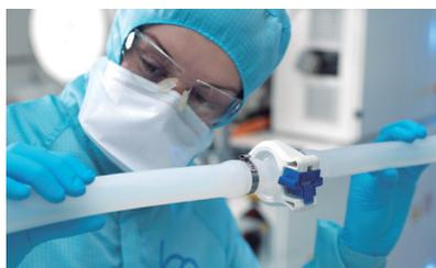
Os tubos PureWeld XL da Watson-Marlow Fluid Technology Group (WMFTG) oferecem uma maior vida útil e consistência de fluxo constante, superando os desafios técnicos associados ao bioprocessamento contínuo. Os resultados de um estudo recente demonstram uma vida útil mais longa e um fornecimento de fluxo sustentável para bombas peristálticas em comparação com tubos de TPE (elastômero termoplástico) da concorrência.
