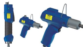
A Kolver ampliou a gama de torque da série K-Ducer para incluir torques muito baixos - toda a esta série agora abrange uma gama de torque de 0,1 a 15 Nm. As novas KDS-MT estão disponíveis com uma estrutura em linha, na opção de punho da pistola (com conector superior ou inferior) e com revestimento de alumínio para aplicações automatizadas.
