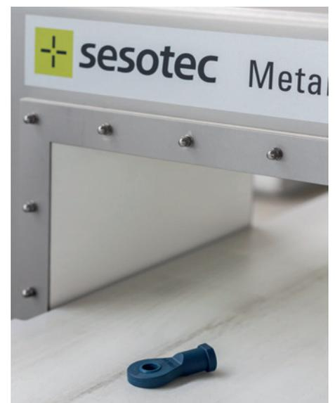
**Figura 2.** Nos detetores de metais da Sesotec GmbH, até fragmentos com menos de 0,02 g dos novos materiais da igus foram detetados. (Fonte: igus GmbH).
