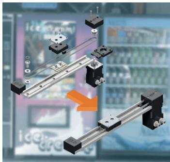
O novo módulo linear drylin ZLN surgiu da combinação da guia linear de baixo perfil drylin N com uma correia dentada, obtendo uma solução muito compacta e económica. Pode ser instalado de maneira rápida e fácil nos espaços mais reduzidos, quer seja em máquinas de venda automática, serviços de robótica ou mesmo em sistemas de automação. A guia linear drylin N assegura uma construção
