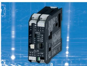
A Seneca expande a gama de *dataloggers* IIoT com o Z-LTE. Este equipamento inclui funções lógicas, controlo remoto e alarme, oferecendo desempenho e estabilidade também para PLC/HMI. Esta solução integra *modem* 4G LTE, 4 portas de comunicação, 8 canais I/Os, recetor GPS, bateria UPS e apoio para comandos alarmes/áudio com tons DTMF.
