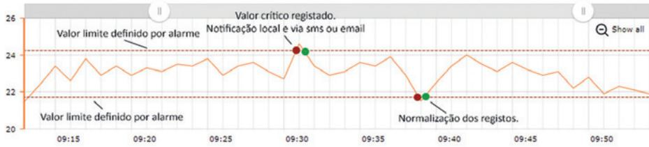
Figura 3. Comportamento do sistema de alarmes aquando dos desvios do processo.
