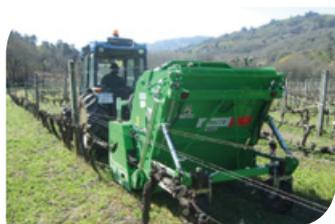
Figura 5 Equipamento de dentes fixos e contra-lâmina.
