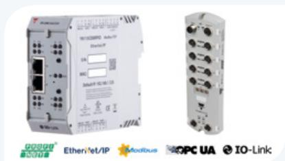
A Carlo Gavazzi Automation, lança no mercado os IO-Link “Master”, Série Y. Os novos IO-Link Masters YL212 e YN115 suportam os principais protocolos, como Ethernet/IPTM, PROFINET IO e MODBUS TCP. Além
