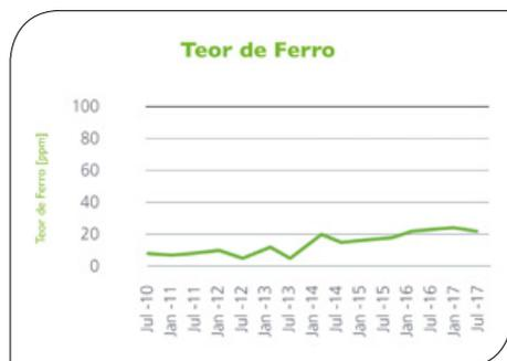
O RENOLIN UNISYN CLP 320 apresenta uma excelente estabilidade do filme lubrificante, uma boa relação viscosidade-temperatura, excelentes propriedades de proteção anticorrosiva e contra o desgaste, mesmo depois de 8 anos de uso em caixas de engrenagens de turbinas eólicas.
