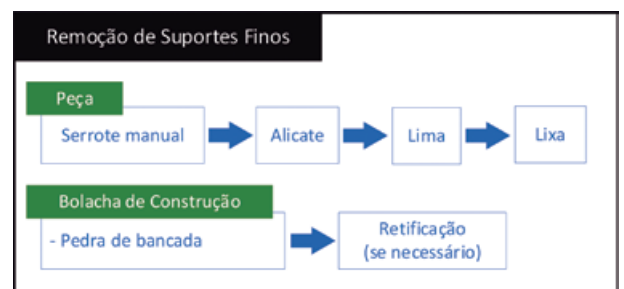
Figura 13. Etapas a ter em conta para a remoção de suportes finos.
