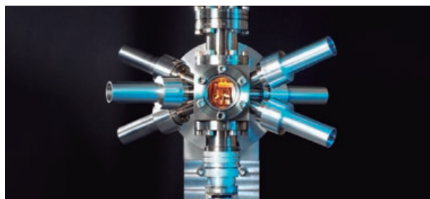
Figura 1. Exemplo de relógio atómico à base do átomo de ^{133}\text{Cs} , usado na realização do segundo do SI.
