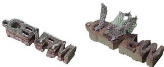
Figura 7. Empeno e queima provocados por excesso de calor.
