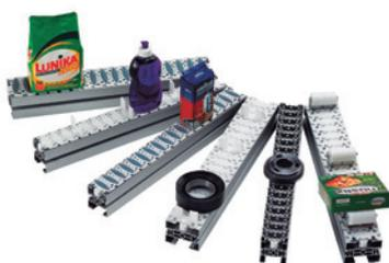
As sete tipologias de correntes (correntes planas, de arrastamento e de atrito, roletes de acomodação, etc.) e as larguras de 65, 90, 120, 160, 240 e 320 mm permitem que o VarioFlow *plus* se adapte facilmente ao tamanho e ao tipo de material a ser transportado. 📌
