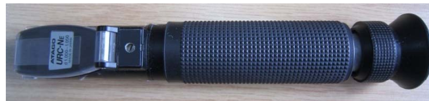
Refratómetro utilizado para medir a densidade da amostra
