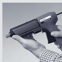
Colocar a cabeça térmica no punho
