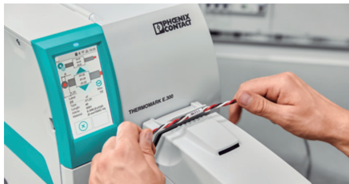
Figura 2. Economia de tempo de até 60%: impressão e aplicação da marcação de fio em apenas uma única etapa de processo automatizado. Graças ao software integrado, os dispositivos Thermomark E SERIES também podem ser usados remotamente para implementar intuitivamente projetos de identificação de fios diretamente no quadro de comando.
