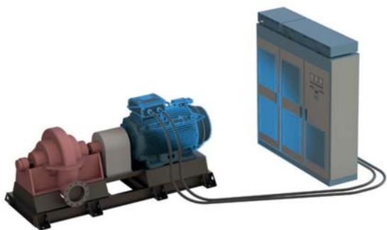
Figura 2. Sistema esquemático de acionamento de motor elétrico
