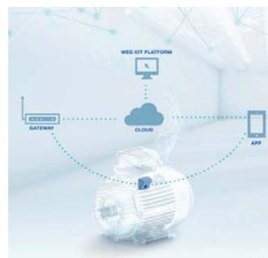
Figura 4. Sensores e conexão à Cloud dos motores
