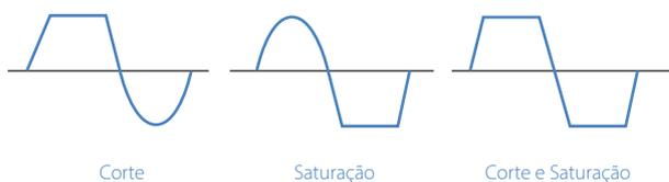
Figura 175. Formas de onda provocadas pelo corte e saturação do transistor.
