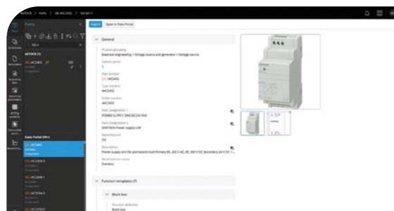
**Figura 2.** Se um dispositivo for aberto no EPLAN Data Portal, pode ser importado para o eStock com apenas um ou dois cliques.
