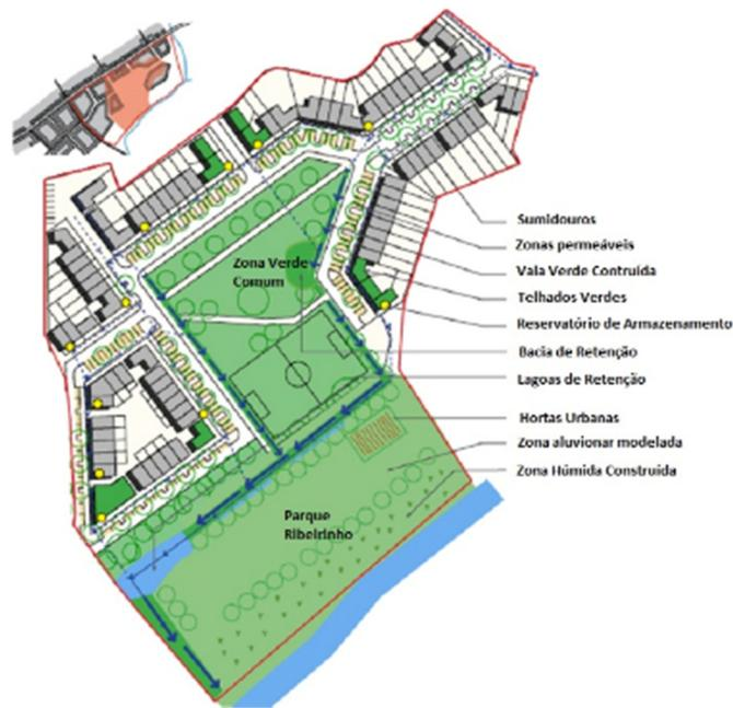
Figura 13 | Planeamento detalhado do layout do local (fonte: *EHLG/IG, 2009*)
