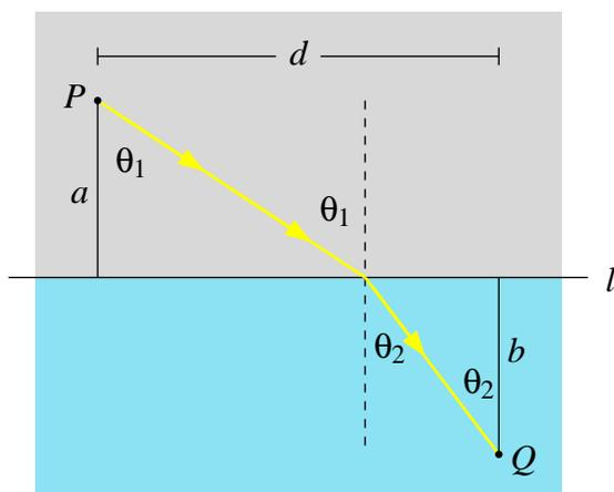
A figura ao lado representa, esquematicamente, o percurso de um raio de luz desde o ponto  $P$  até ao ponto  $Q$ , que atravessa uma recta  $l$  que separa dois meios homogêneos com diferentes densidades. Sejam  $v_1$  a velocidade de propagação no meio que contém  $P$  e  $v_2$  a correspondente velocidade no meio que contém  $Q$ . Designe-se por  $\theta_1$  e  $\theta_2$  os ângulos de incidência e de refração, respectivamente.
