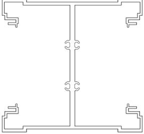
**PAL Capa de Calha Técnica H/V / INWALL DIVISÓRIAS**
