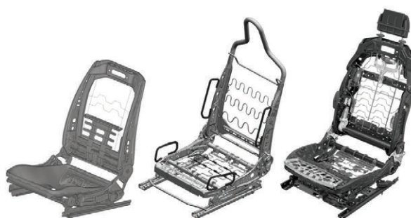
Figura 1. Estruturas típicas de bancos dianteiros: (à esquerda) com componentes obtidas por estampagem de chapa; (ao centro) com elementos de ligação transversal normalmente tubulares; (à direita) componentes estruturais obtidos por diferentes processos, unidos por soldadura e/ou rebiteagem [6].
