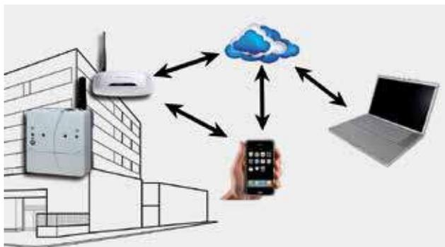
Permite acceder a todos los parámetros del cuadro de control de la caldera de forma remota mediante PC, smartphone o tablet.
