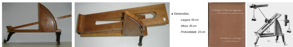
Figura 1. Plano inclinado, dimensões e respetiva imagem no catálogo da Leybold de 1903
