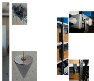
Figura 1. Fotos dos pêndulos simples e físico
