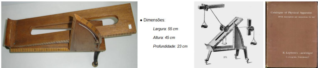
Figura 1 - Plano inclinado, dimensões e respetiva imagem no catálogo da Leybold de 1903.
