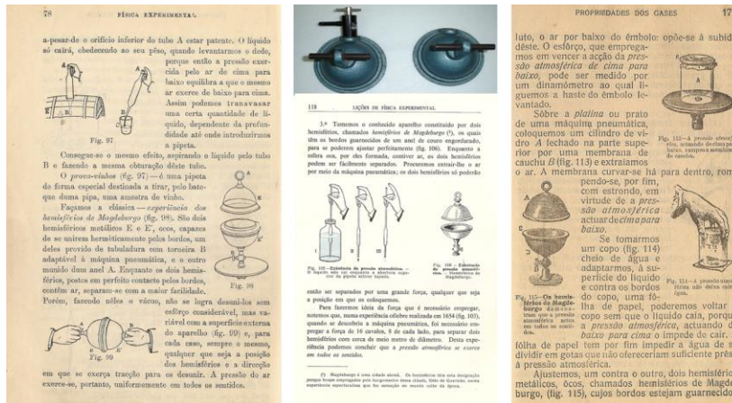
Figura 3 - Hemisférios de Magdeburgo e referências à sua experiência em manuais de Física Experimental de 1936, 1960 e 1906.
