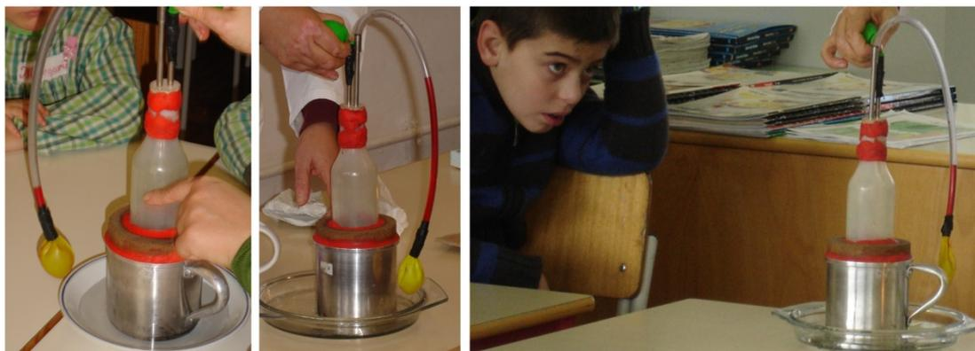
**Figura 3.** Contração do ar quando exposto a uma fonte fria e ocupação do espaço pela água corada.
