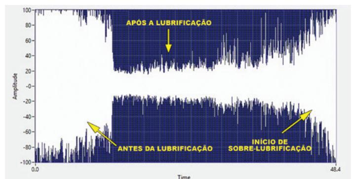
**Figura 4.** Forma de onda ao longo do tempo de ultrassons gravados de um rolamento que foi lubrificado em excesso. Observe o aumento gradual da amplitude (direita) à medida que o lubrificante é adicionado.
