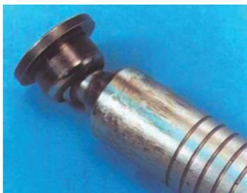
Figura 6. Pistão de bomba axial. Desgaste devido à presença de água no óleo.
