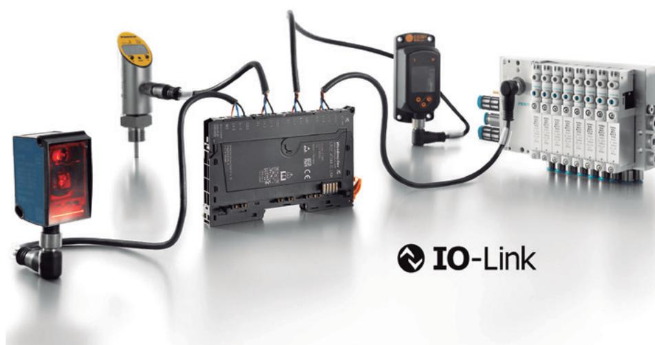
**Figura 4.** O módulo master IO-Link com o grau de proteção IP20, bem como sensores e atuadores conectados. O módulo *master* fornece uma maior fonte de alimentação de 500 mA por canal.
