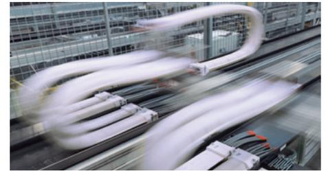
A igus desenvolveu o e-skin para o setor de fornecimento de energia em áreas de produção limpas. Este permite o fornecimento de dados, fluidos e energia a sistemas móveis sem gerar partículas causadas pelo atrito acima do limite, que poderiam contaminar o espaço. A proteção articulada tapada para aplicações em salas limpas ficou em 2.º lugar no prémio de tecnologia limpa da Fraunhofer, entregue em fevereiro de 2018.
