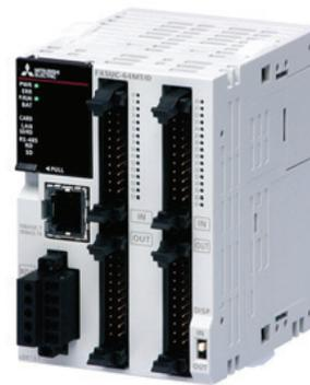
O novo controlador do FX5 pode realizar tarefas ainda mais complexas de posicionamento, sem quaisquer módulos adicionais. São intrínsecas em todas as unidades base, as funções com contadores rápidos e saídas de impulsos até uma frequência de 200 kHz, o que permite controlar até 4 eixos independentes. A série MELSEC FX5 também é compatível universalmente com as gerações anteriores e oferece migração fácil e de baixo custo a partir do MELSEC FX3. Com um
