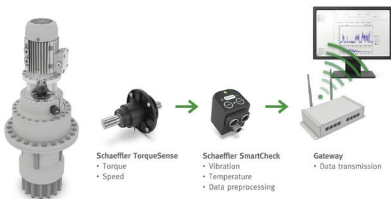
**Figura 2.** Atualmente, a Schaeffler está a desenvolver um projeto-piloto inicial para os motorreductores do sistema de seguimento do vento da Bonfiglioli. Nesta aplicação, os dados de carga compilados com o SmartCheck da Schaeffler são comparados com os valores-limite predefinidos e os resultados são transmitidos sem fios para a Bonfiglioli através de uma porta de ligação.
