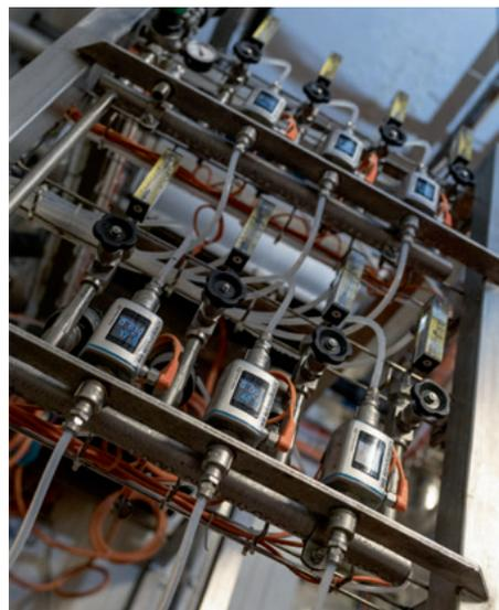
Figura 3. Graças ao Picomag, os espaços reduzidos não são um obstáculo para uma medição precisa de caudal.
