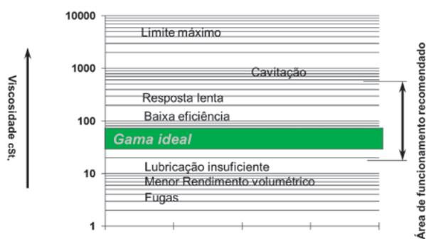
Figura 2. Viscosidades para sistemas hidráulicos.
