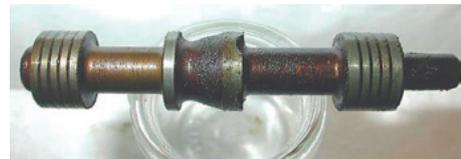
Figura 7. Verniz devido à presença de água.
