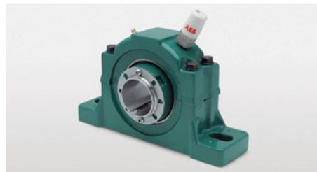
A ABB lançou o ABB Ability™ Smart Sensor para chumaceiras da Dodge, parte do portefólio da ABB Ability™ Digital Powertrain, que permite "verificações do estado" das mesmas. A tecnologia de sensor inteligente constitui um indicador antecipado de qualquer potencial problema, avaliando o estado dos rolamentos a partir da vibração e da temperatura,
