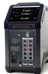
O ADT875-155 é o novo calibrador de bloco seco da Additel que combina uma ótima estabilidade, uniformidade radial e axial, com rapidez. Com este calibrador a Additel entra na calibração da temperatura e com a opção PC acrescentamos as capacidades de leitura de 3 canais de temperatura com um calibrador de processo.
