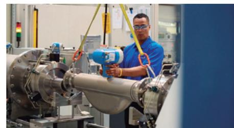
**Figura 2.** Equipamento de calibração certificado. Os caudalímetros são calibrados para cumprir os requisitos aplicáveis, tal como o Laboratório de Calibração Certificado ISO/IEC 17025 A2LA da Endress+Hauser, em Greenwood, IN.
