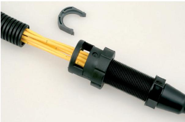
Figura 4. Vista detalhada de um distribuidor de fibras impermeável. É montado com um parafuso de junta compatível para instalação nas caixas de fusão da HELUKABEL. Adicionalmente o *kit* pode ser reutilizado.
