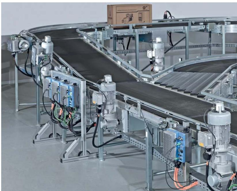
Figura 1. As unidades de acionamento descentralizado da NORD Drivesystems podem ser integradas de modo flexível em fábricas.
