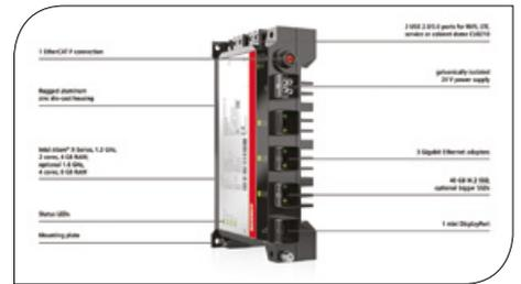
é adequado para utilização em temperaturas até +50 °C. Apresenta uma ampla gama de interfaces (3 x LAN, 2 x USB, mini DisplayPort, EtherCAT P), um mínimo de 40 GB M.2 SSD com Flash 3D e CPU Intel Atom® integrado (até 4 núcleos) com suporte contínuo para TwinCAT 3. Todas estas características tornam o C7015 na plataforma ideal para diferentes tarefas simultâneas: automação de alto desempenho sob condições adversas em tempo real, visualização e comunicação.
