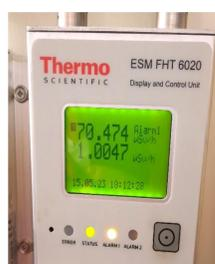
Figura 5. Radioatividade na sala onde se encontram os aceleradores desligados e na sala ao lado.
