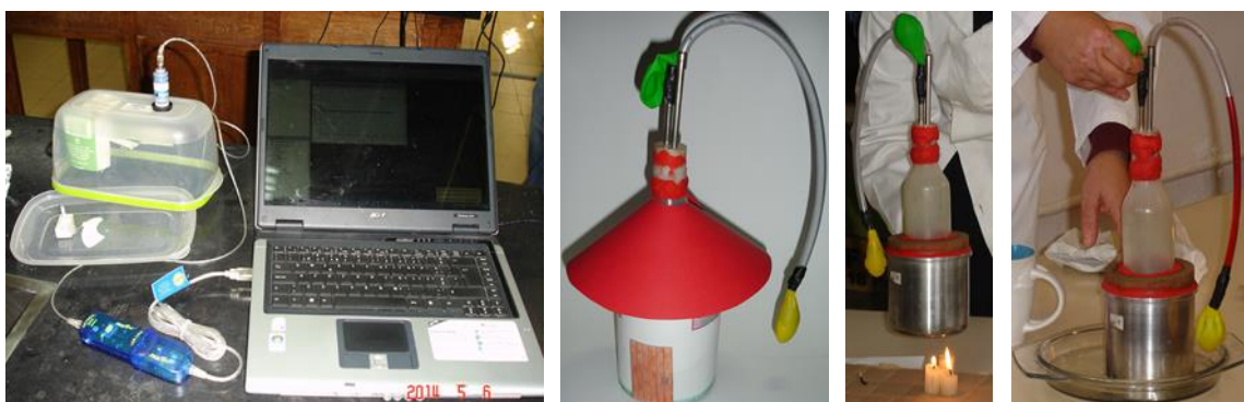
Figura 9 Montagem experimental para medir a concentração de oxigénio durante a combustão e instrumento que permite verificar a dilatação e contração do ar.
