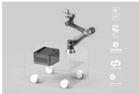
A série móvel TM-M da Techman Robot, composta pelas versões TM5M-700, TM5M-900, TM12M-1300 e TM14M-1100, é alimentada a 20-60V DC, tornando-a compatível com a maioria das marcas de AGVs e outros veículos moveis. Através do uso dos "TM - Landmark", os robots moveis podem orientar-se num espaço 3D, como uma sequência de dados automática, para servir várias máquinas. Isto faz com que os TM-M possam operar entre 2 ou mais posições sem problemas.
