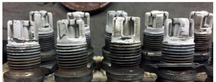
Figura 7. Bom controlo dos depósitos de cinzas sem incrustações nas velas de ignição.
