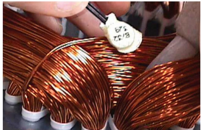
Figura 7.6 - Instalação do protetor térmico bimetálico
